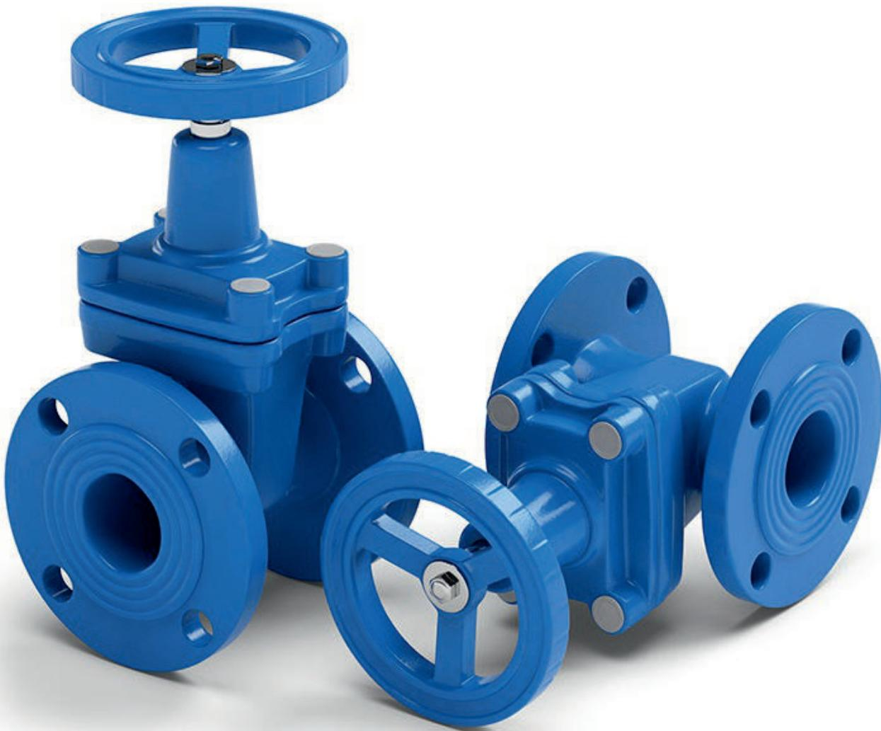
**Задвижка** — трубопроводная арматура, в которой запирающий или регулирующий элемент перемещается перпендикулярно оси потока рабочей среды. Задвижки — очень распространённый тип запорной арматуры. Они широко применяются практически на любых технологических и транспортных трубопроводах диаметрами от 15 до 2000 миллиметров в системах жилищно-коммунального хозяйства, газо- и водоснабжения, нефтепроводах, объектах энергетики и многих других при рабочих давлениях до 25 МПа и температурах до 565 °C
